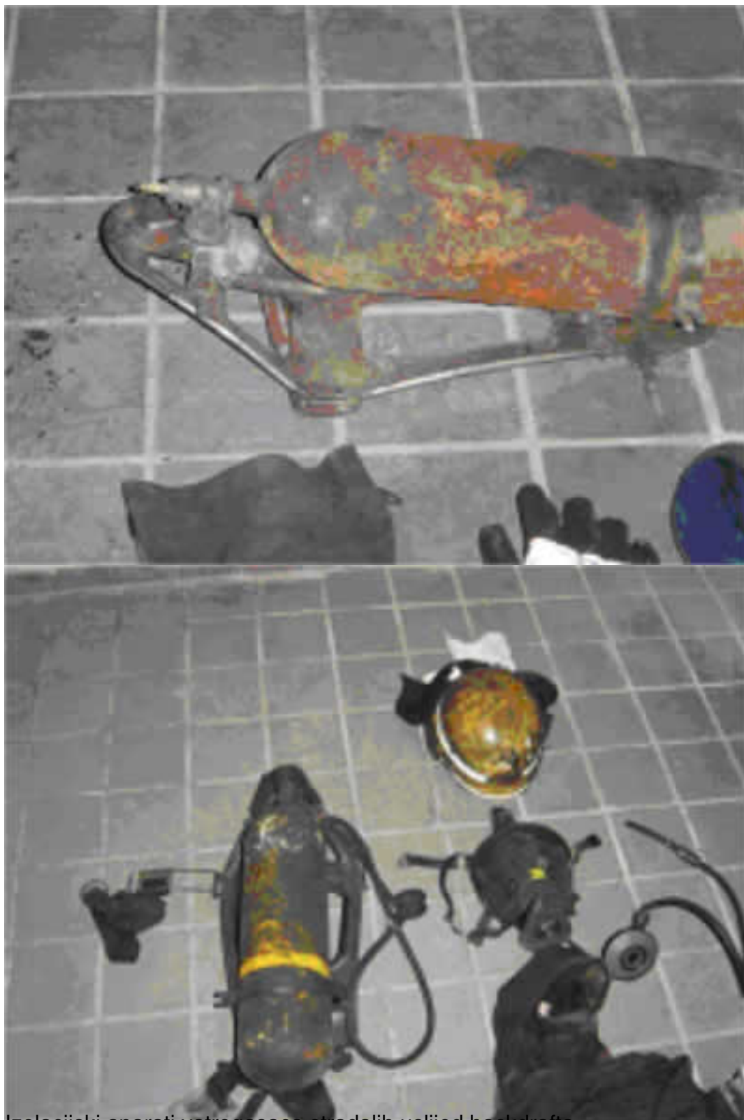
Izolacijski aparati vatrogasaca stradalih uslijed backdrafta
